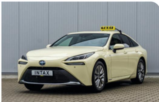
Mit dem Toyota Mirai wird auch die Taxi-Umrüstung eines Fahrzeugs mit Brennstoffzelle angeboten.
