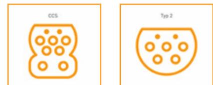
Bei CCS handelt sich um einen Typ-2-Stecker, der um zwei Gleichstromkontakte erweitert wurde. Fast alle Autohersteller nutzen inzwischen diesen CCS-Standard. Bei einigen asiatischen E-Autos ist für das DC-Laden noch das CHAdeMO-System zu finden.
